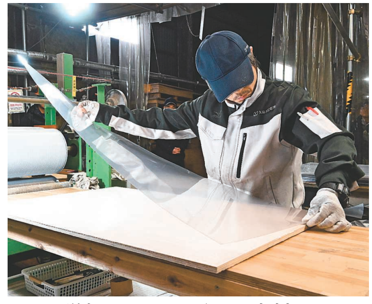
単板にペットボトル素材の樹脂シートを貼る従業員
